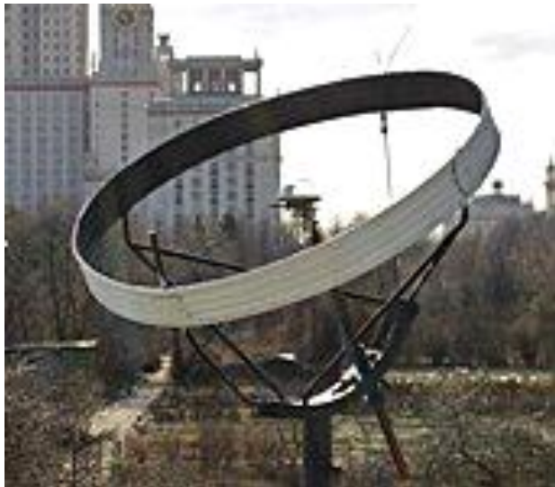
Фото 12. Тіньове кільце з піранометром для реєстрації розсіяної радіації
