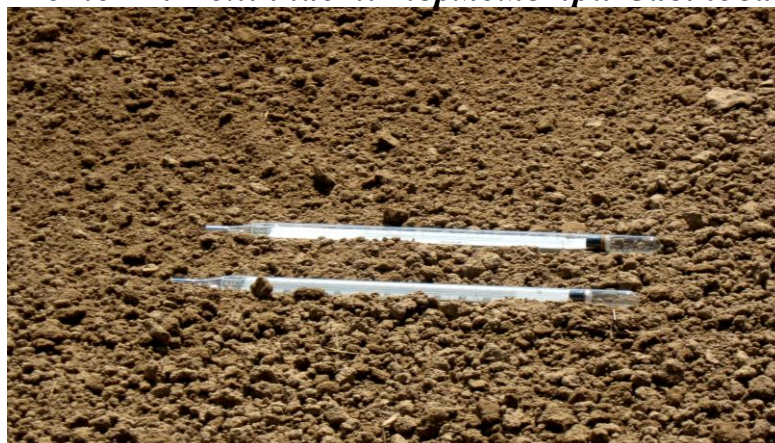
Фото 23. Максимальний та мінімальний термометри для вимірювання температури поверхні ґрунту
