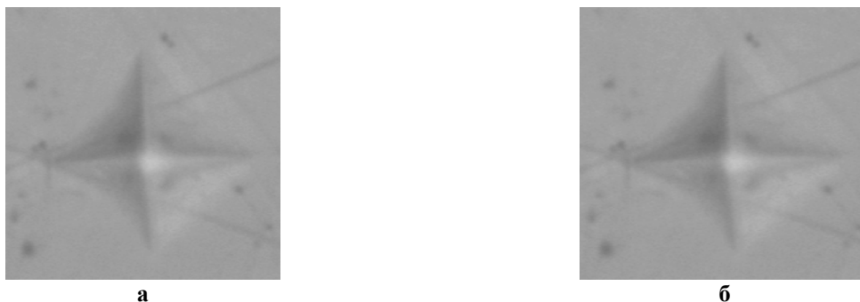
Рис. 4. Відбиток чотиригранної алмазної піраміди на поверхні склоподібних сплавів складу Ge_9Ga_2S_{21} (а) та Ge_8Ga_4S_{22} (б)
