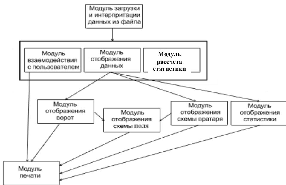
**Рис.1. Блок-схема структури програмного модуля «TsL-handball»**
