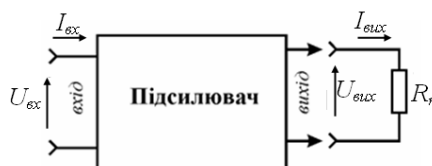
Рис. 13.1.2. Підсилювач електричних сигналів як чотириполіусник.
