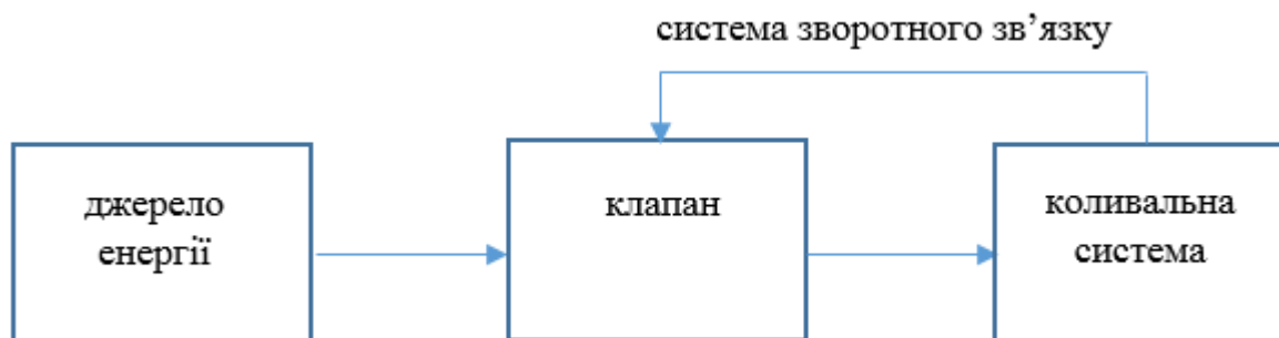
Рис. 17.1.2. Блок-схема автоколивальної системи
