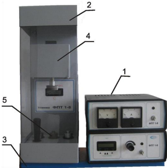
Рис. 25.1. Загальний вигляд експериментальної установки ФПТІ-8: 1 – блок приладів; 2 – блок робочого елемента; 3 – стаяк; 4 – нагрівник; 5 – досліджувані зразки
