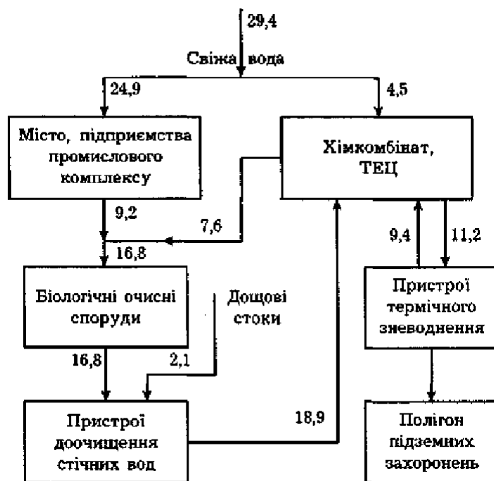
Рис. 13.4. Комплексна схема і баланс споживання води з використанням стічних вод хімічного комбінату, ТЕЦ, міста та підприємств промислового комплексу (цифри – витрата води в тис. м 3 /добу з вирахуванням безповоротних втрат)
