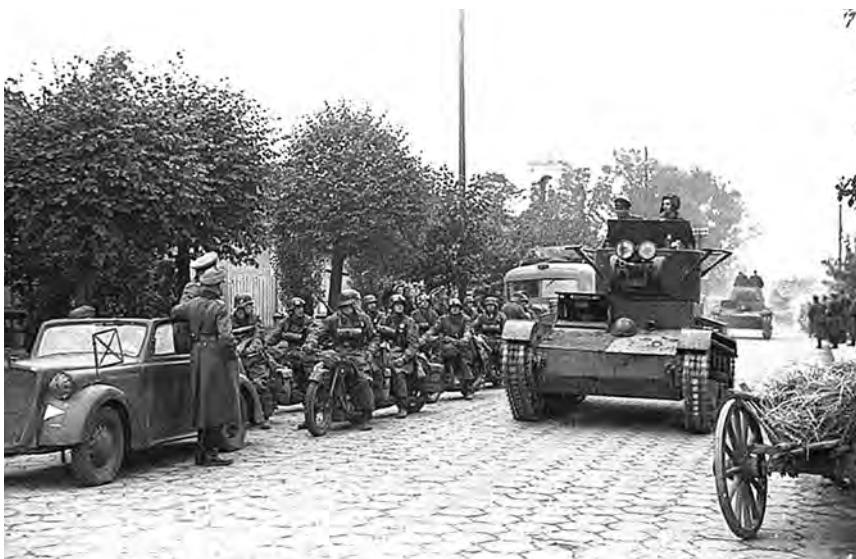
Рис. 217. Фрагмент параду в Бресті 22 вересня 1939 р. Радянська танкова колона проходить повз групу німецьких мотоциклістів. На передньому плані – «командирський» танк Т-26 зразка 1933 р. з поручневою антеною
