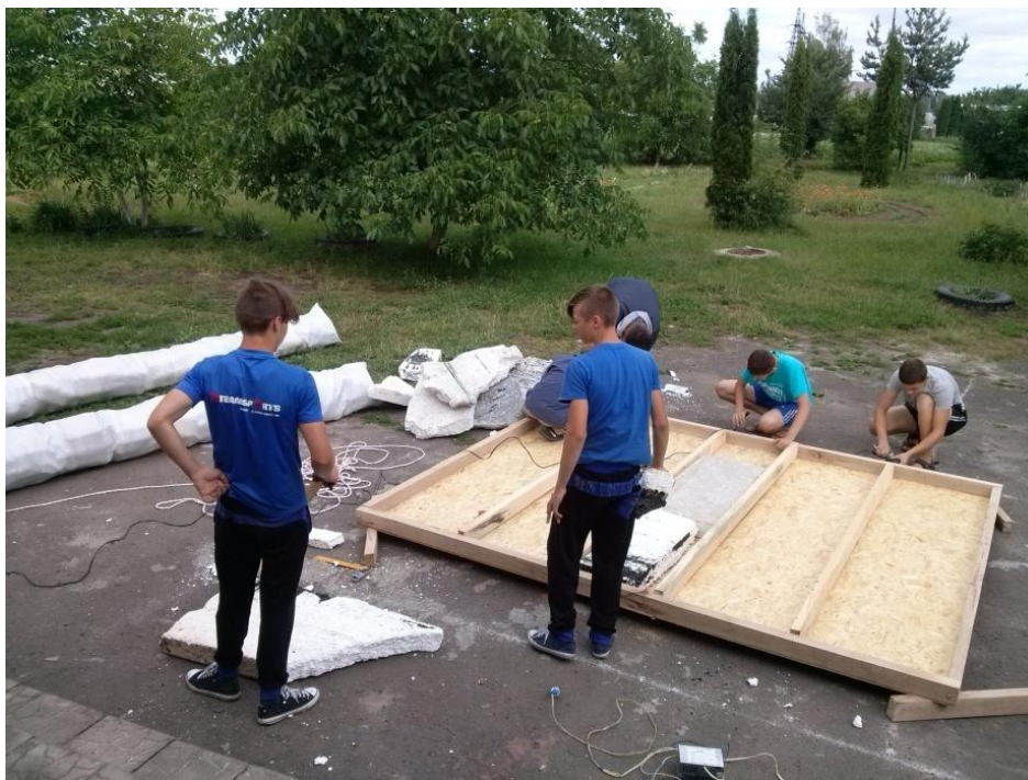
Рис. 8.1. Виготовлення каркасу плоту
