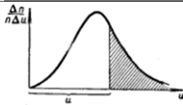
Рис. 1.23 Площа заштрихованої фігури дає відносну кількість молекул, швидкості яких більші даного значення u
