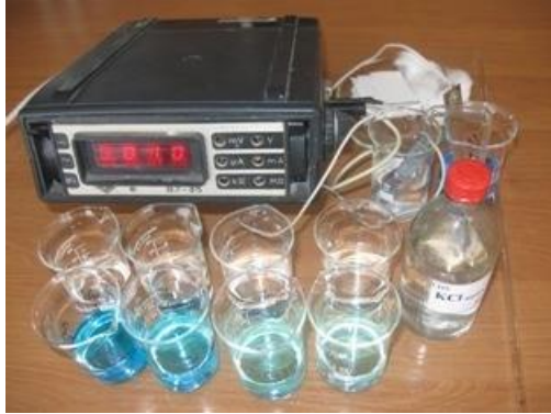
Рис. 4.1. Зовнішній вигляд зібраної схеми для вимірювання ЕРС елемента Данієля-Якобі вольтметром В7-35.
