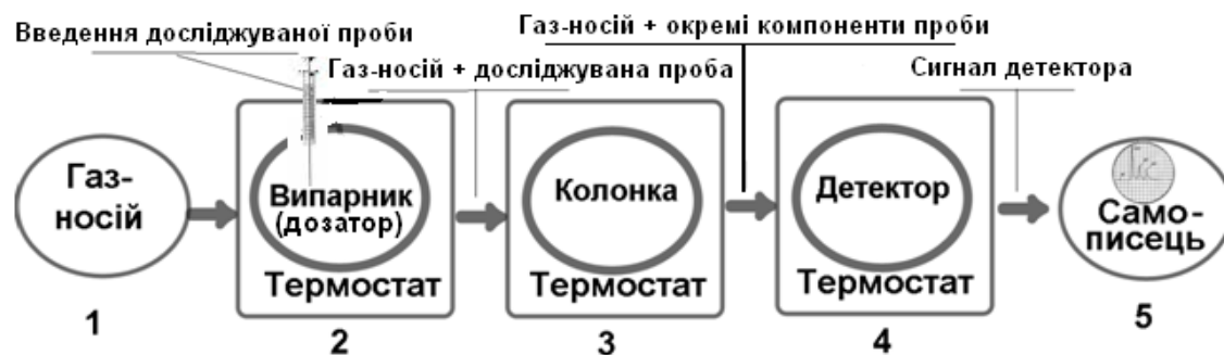
Рис. 2. Спрощена схема процесу газохроматографічного розділення
