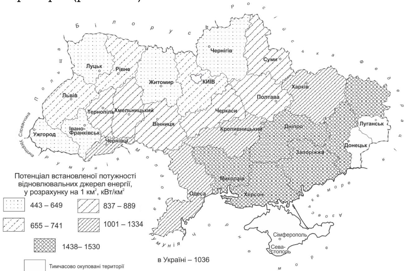
Рис. 2.11 Потенціал максимально можливої встановленої потужності відновлювальних джерел енергії регіонів України у розрахунку на 1 км 2 , кВт/км 2 , [2]
