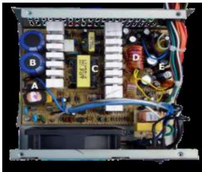
Рис. 5.6. Імпульсний блок живлення комп'ютера (АТХ): А – вхідний діодний випрямляч, нижче видно вхідний дросельний фільтр; В – конденсатори вхідного фільтра, правіше – радіатор високовольтних транзисторів; С – імпульсний трансформатор, правіше видно радіатор низьковольтних діодних випрямлячів; D – дросель групової стабілізації; Е – конденсатори вихідного фільтра.
