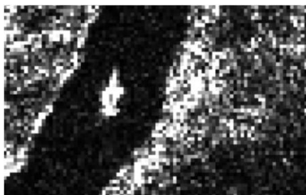
Рисунок 5.27 – Збільшений фрагмент радіолокаційного знімка, на якому чітко видно спекл-шум
