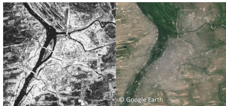
Рисунок – 5.19 Зображення урбанізованої забудови на радіолокаційному знімку Radarsat-2 (зліва) і знімок у видимому діапазоні (справа)
