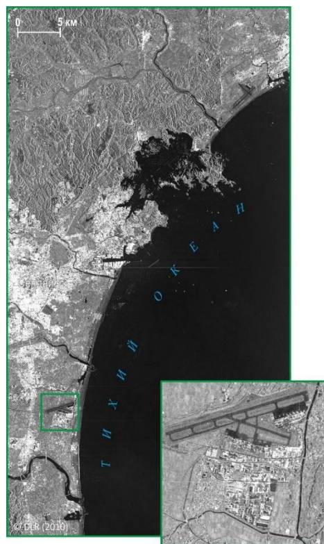
Рисунок 5.10 – TerraSAR-X, г. Сендай, Японія. Режим зйомки StripMap: просторова роздільна здатність 3 м, ширина полоси знімання 30 км
