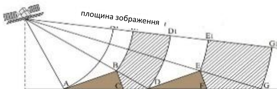
Рисунок 5.43 – Схема формування радіолокаційної тіні
