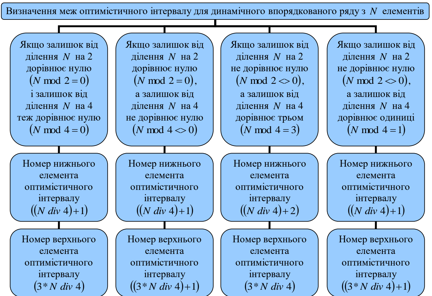
Рис. 3.4. Формули визначення меж оптимістичного інтервалу в алгоритмічній мові Turbo Pascal
