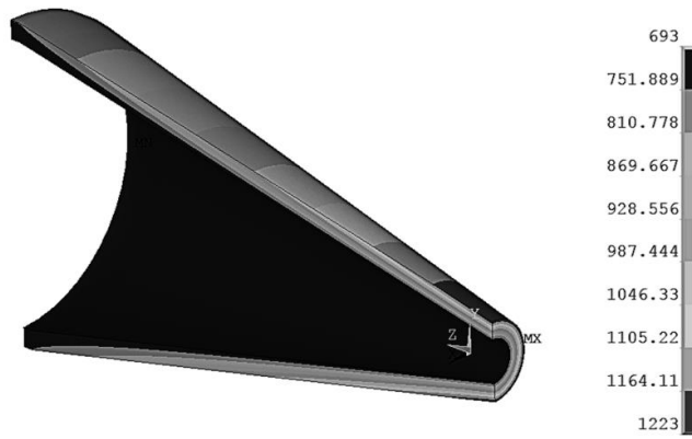
Рисунок 1. Розподіл температури за об'ємом оболонки, градуси К
