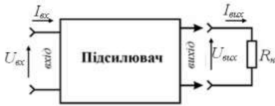
Рис. 3.6. Підсилювач електричних сигналів як чотириполюсник
