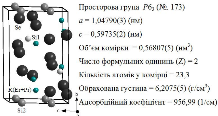
Рис. 5.22. Елементарна комірка та основні характеристики кристалічної структури Er_{1,5}Pr_{1,5}Si_{1,67}Se_7 .
