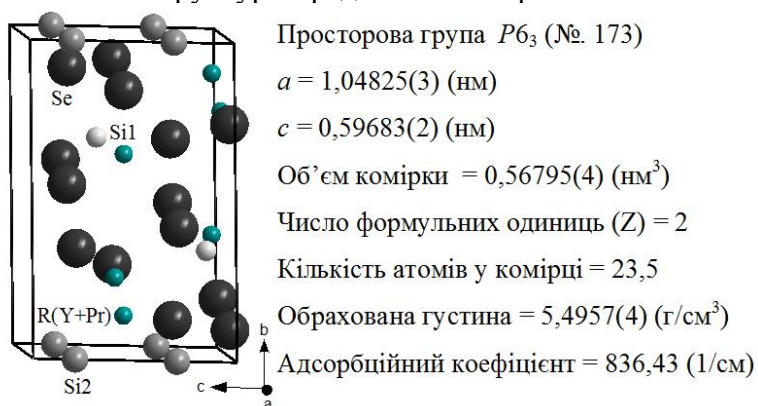
Рис. 5.7. Елементарна комірка та основні характеристики кристалічної структури Y_{1,5}Pr_{1,5}Si_{1,75}Se_7 .
