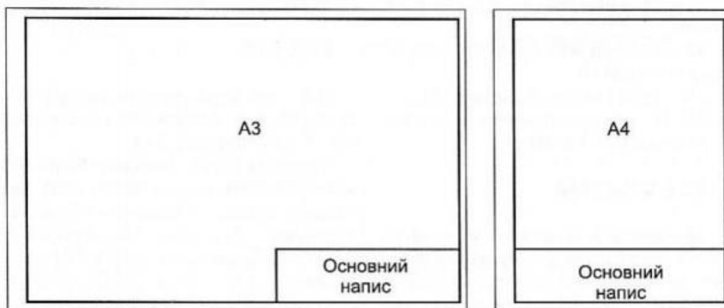
Рис. Д.2 – Розміщення основного напису на форматах
