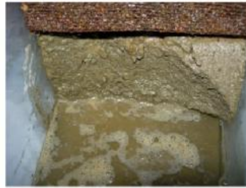
Обвалення борту та забутовування солевмісної товщі в експериментальній моделі
