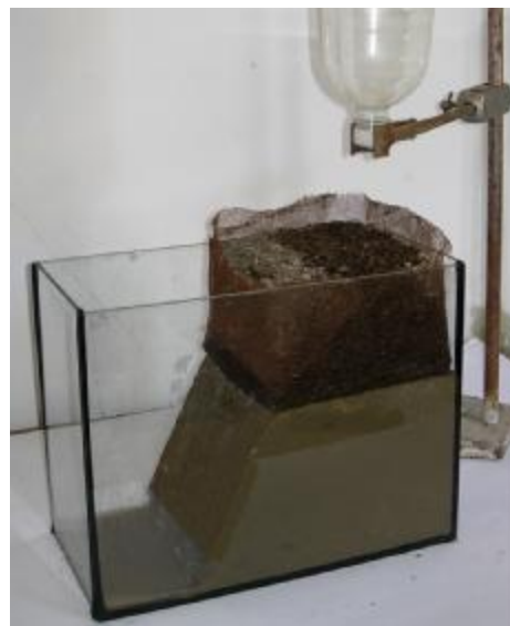
Рис. 6. Схема моделі для дослідження процесів, які супроводжують затоплення соляного кар'єру
