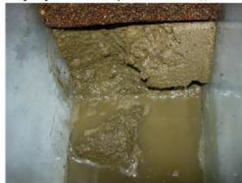
Обвалення борту над нішею вилюговування в експериментальній моделі
