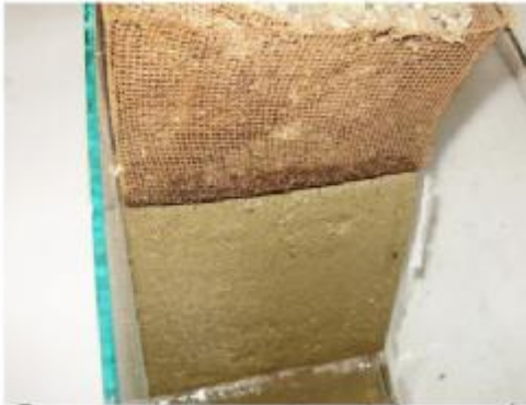
Площинний розвиток карсту на рівні соляного дзеркала в експериментальній моделі
