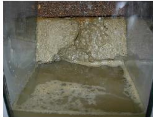
Ерозійний розмив борту над нішею вилюговування в експериментальній моделі
