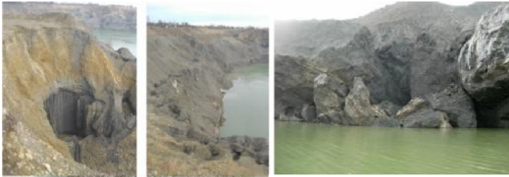
Обвалення бортів, забутовування й самоізоляція солевмісних товщ у затоплюваному кар'єрі
