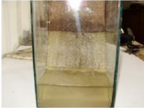
Субвертикальний розвиток карсту з формуванням порів у борті кар'єру в експериментальній моделі
