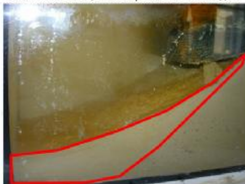
Самоізоляція солевмісної товщі зі сформуванням стійкого профілю дна в експериментальній моделі. Лінією оконтурена ізолювальна глиниста товща
