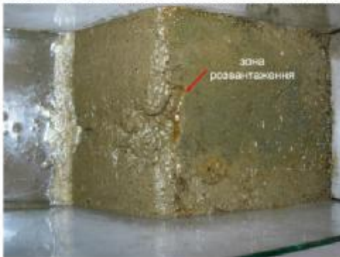
Об'ємна дезінтеграція борту внаслідок тривалого карстування в борті та зони розвантаження експериментальної моделі
