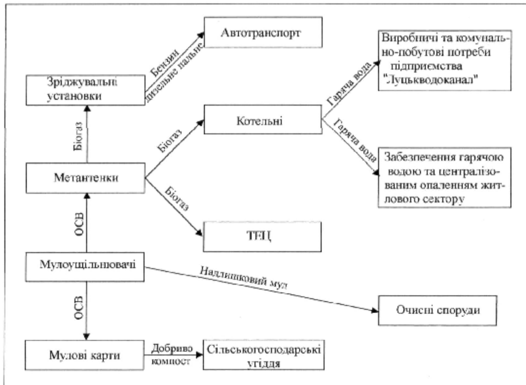
Рис. 1. Схема комплексного використання відходів очисних споруд підприємства "Луцькводоканал"
