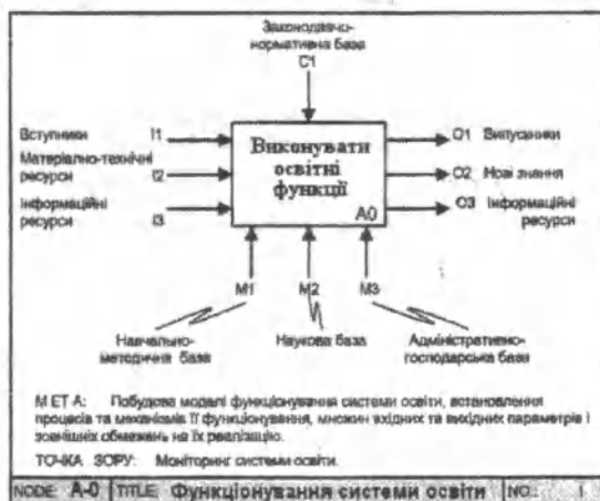
Рис. 2. Контекстна діаграма A-0 моделі функціонування системи освіти на дочірній діаграмі. Цим досягається структурна цілісність IDEF0-моделі.
