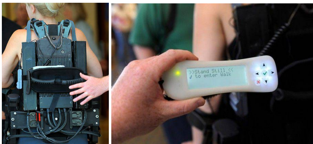
Рис. 7. Блоки управління екзоскелетом-системою eLEGS
