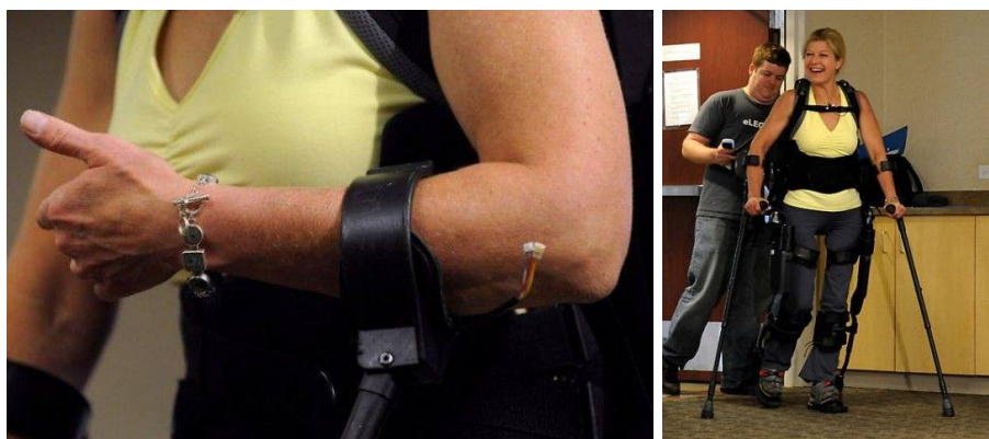
Рис. 6. Інтерфейс людина-машина екзоскелета-системи eLEGS
