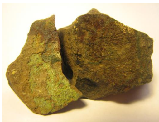
Рис. 2. Зразок базальту із самородною міддю (справа); проба оброблена FeCl 3 (зліва)
