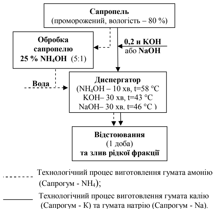
Схема 1. Технологічний процес виготовлення гумінових препаратів із сапропелю
